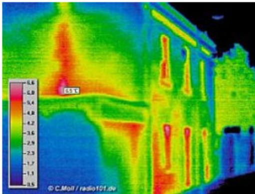
Bild 7-1 Thermografiebild eines Hauses
