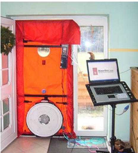
Bild 7-4 Blower-Door-Messung (hier an einer Haustür)
